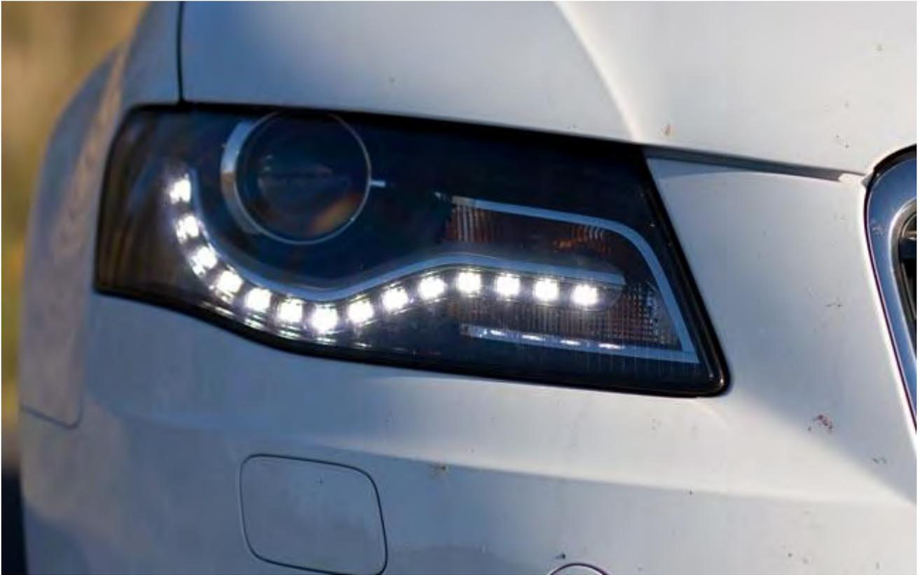
Los sistemas DRL (Daylight Running Lamps), traducido al español “Luces de circulación diurna”, son un tipo de luces instaladas en todos los vehículos que actualmente salen al mercado y son luces pensadas para ser vistos y no para iluminar.
