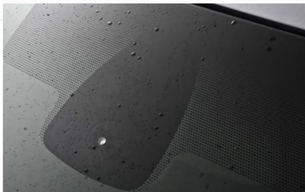
retrovisor). Lo habitual es que este sensor sea un **fotodiodo** (de nuevo un diodo y un material semiconductor) que es excitado por la luz y genera cierta corriente eléctrica.
