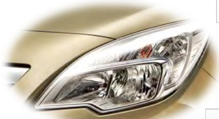
Lámparas **halógenas**: el principio es el mismo, solo que si en lugar de vacío se rellena la ampolla con un gas halógeno, el filamento dura más y desprende más luz (con el mismo consumo) y más blanca.
