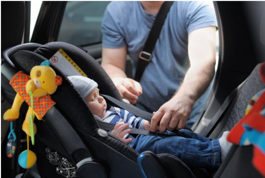
Recomiendan de igual modo que si se tiene «un asiento dotado del sistema de sujeción **ISOFIX**, la recomendación general es instalar dicha sillita en una de la plazas del vehículo dotadas de dicho sistema, para así poder beneficiarte de
