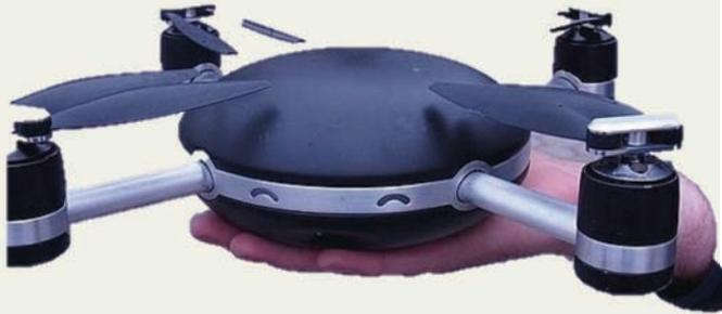
El dron -como se conocen a los vehículos aéreos no tripulados- que están diseñados solo para volar, Lily Camera se centra en su objetivo. Este dispositivo se define como una cámara-drone que no requiere de una persona para manejarlo a distancia, ya que funciona a través de un GPS que sigue a su objetivo por los aires mientras graba cada movimiento gracias a una cámara que se asemeja a la GoPro Hero3 (12 MPX, 1.080 p, 60 fps).
