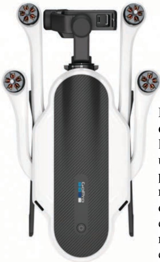
**El nuevo drone Karma de GoPro destaca por su diseño.** Para empezar, lo que más llama la atención es que es un drone plegable, que facilita el que puedas llevarlo siempre contigo y con el resto de los accesorios. Sus hélices se desmontan y los brazos se pliegan hacia el cuerpo para hacerlo uno de los drones más compactos, por no decir el más, de esas características.
