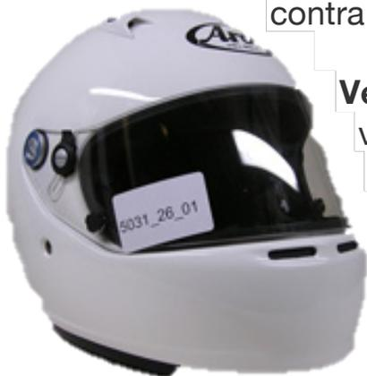
**Velocidad de impacto:** SHARP ha realizado pruebas a las velocidades que marca la normativa UN ECE 22.05 entre 7,5 y 8,4 m/seg (27 y 30 km/h). Aunque han añadido una prueba a 6 m/seg (22 km/h) para analizar el comportamiento del casco en impactos a baja velocidad. Además SHARP recomienda a las autoridades que en sus próximas homologaciones hagan pruebas hasta 9,5 m/seg (34 km/h), con la intención de que los fabricantes hagan cascos todavía más seguros en el futuro.
