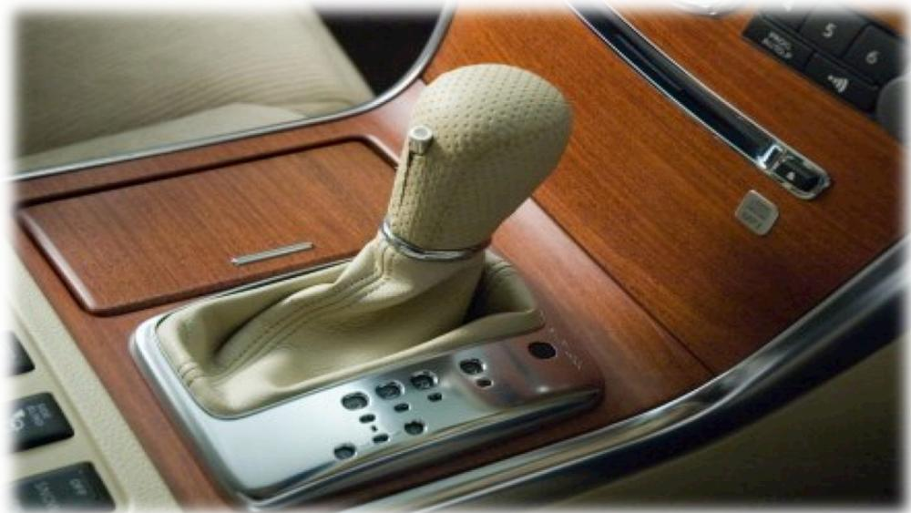
La palanca de cambios del Fuga tiene un sensor capaz de medir el nivel de alcohol gracias a la transpiración de la mano. Si las lecturas sobrepasan los niveles permitidos, el automóvil será inmovilizado. La acción, además, se ve acompañada por un mensaje verbal emitido por navegador GPS. Aparte del sensor del pomo, hay otros dispuestos en los asientos delanteros, capaces de "oler" el alcohol en el aire.
