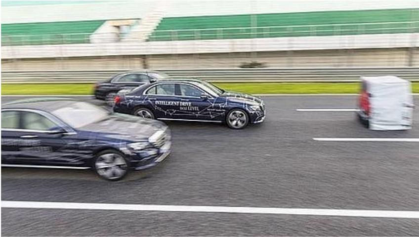
Un radar situado en el frontal del coche, en el caso de que nosotros aceleremos y el radar certifique que tenemos un obstáculo delante, el AEB frenará de forma independiente para evitar el golpe.
