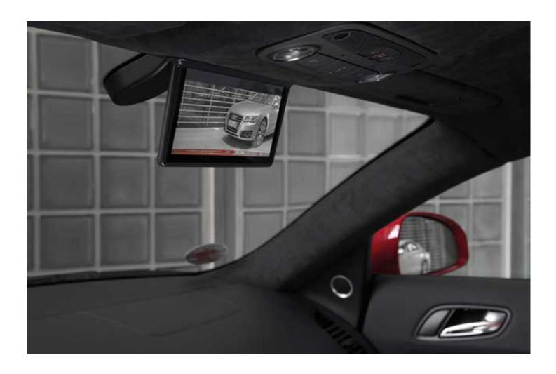
Una pantalla de 7.7 pulgadas a cargo de Samsung trabaja en conjunto con una cámara, reemplazando el espejo del habitáculo.
