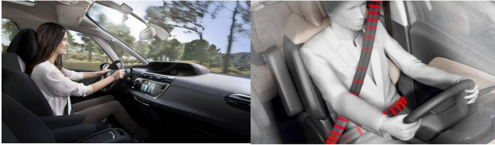
*Citroen C4 Picasso introduce el cinturón con sistema de alertas ante peligro mediante vibración, como aviso de abandono de carril y el de colisión, activando automáticamente un sistema de tensado en el mismo a todos los ocupantes.*
