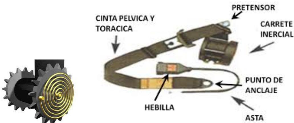
El cinturón se extiende y luego se retrae mediante un sistema mecánico que contiene una bobina y un resorte que permite ajustar la cinta en el cuerpo gracias a la acción de un muelle. En el caso de impacto o movimiento brusco, el retractor bloquea la bobina e impide la expulsión del cuerpo hacia delante.
