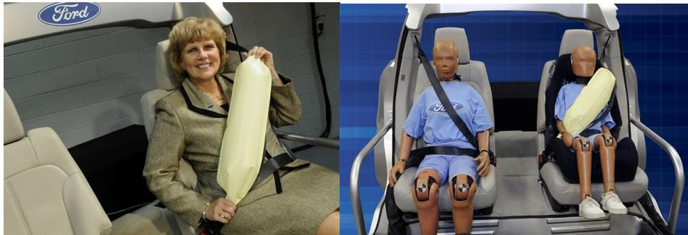
*Ya es una realidad el cinturón de seguridad inflable y el primero en aportar esta tecnología es la Ford Motor Company para ser instalado en todos los cinturones del vehículo desde el 2011.*
