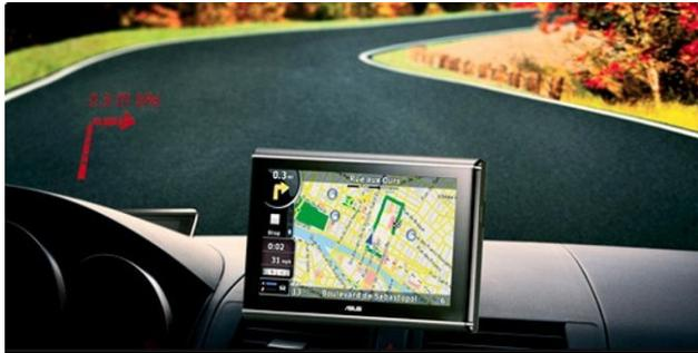
Este es otro navegador **GPS** que permite proyectar datos sobre el parabrisas, se habló en su día de él en Xataka. Consta de dos partes, el navegador propiamente dicho, con su pantalla táctil a color de 5", que se sujeta al parabrisas (como cualquier otro GPS convencional) y una unidad que se coloca sobre el salpicadero y refleja sobre el parabrisas, en monocromo, indicaciones esquemáticas.
