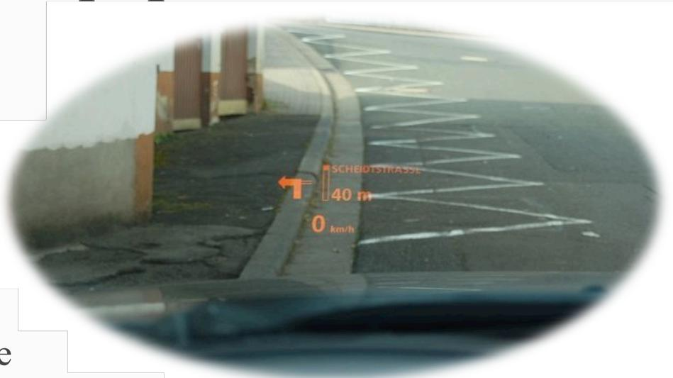
Lo normal es que los datos se proyecten delante del conductor a una altura superior a la del cuadro de instrumentos. Oculto desde la visual del conductor, hay un hueco en la visera que cubre el **cuadro de instrumentos** en el que se sitúa el proyector que generará la imagen sobre el parabrisas. En el parabrisas puede notarse, según la luz, y si se tiene buen ojo, un pequeño recuadro con un matiz o tono ligeramente diferente (es el área específica del combinador).
